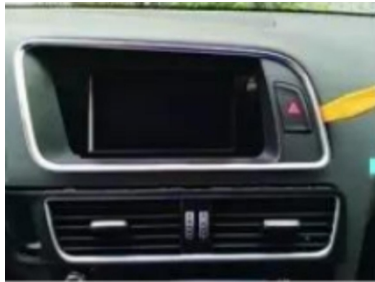
1. Entfernen Sie die Original-Modellabdeckung
