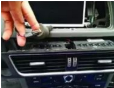
4. Ziehen Sie den Stecker ab und entfernen Sie den Luftauslass
