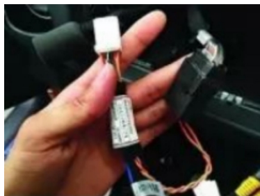
14. Unser Stecker wird mit dem LVDS-Kabel des Originalfahrzeugs verbunden
