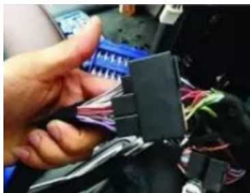
13. Verbindung zwischen unserem Stecker und dem CD-Player-Stecker des Original-Fahrzeugs
