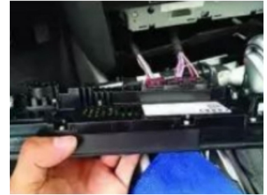
6. Ziehen Sie den Stecker an der Klimaanlage ab
