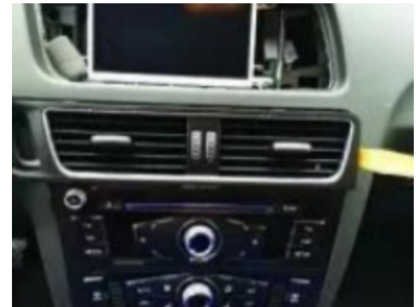
3. Entfernen Sie die Lüftungsblende der Klimaanlage des Originalfahrzeugs
