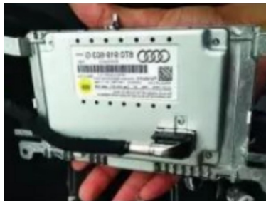
8. Entfernen Sie das LVDS-Kabel des Original-Fahrzeugbildschirms
