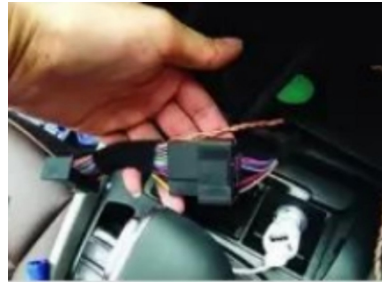
12. Verbindung zwischen unserem Stecker und dem Klimaanlagenstecker des Originalfahrzeugs
